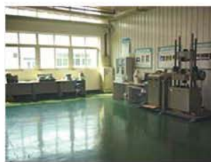
焊接品质检测设备 (金相研磨仪、电子显微镜、拉力试验机、高速摄影机等)
