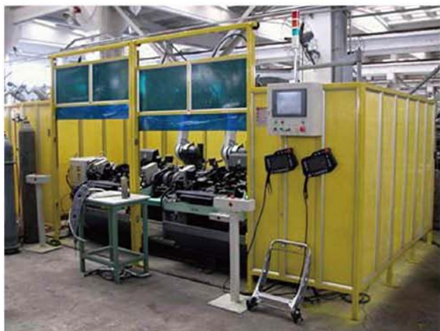
汽车座椅骨架机器人焊接系统
