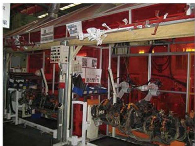
汽车仪表盘支架机器人焊接系统
