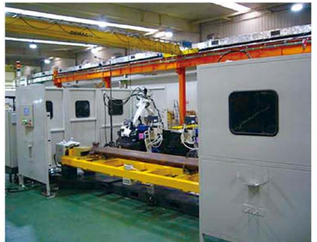
塔吊零部件机器人焊接系统
