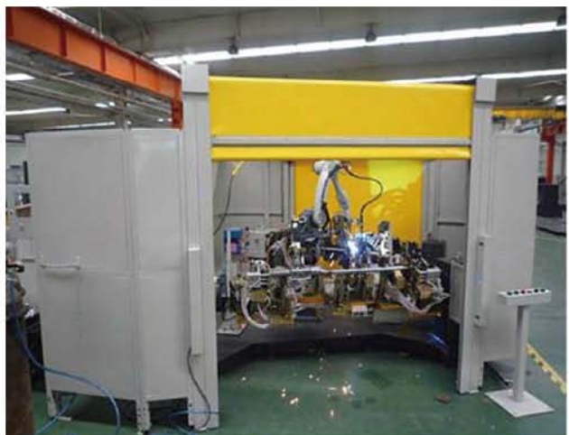
汽车仪表盘支架机器人焊接系统
