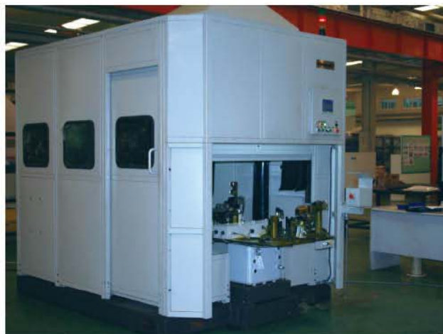
汽车减震器机器人焊接系统
